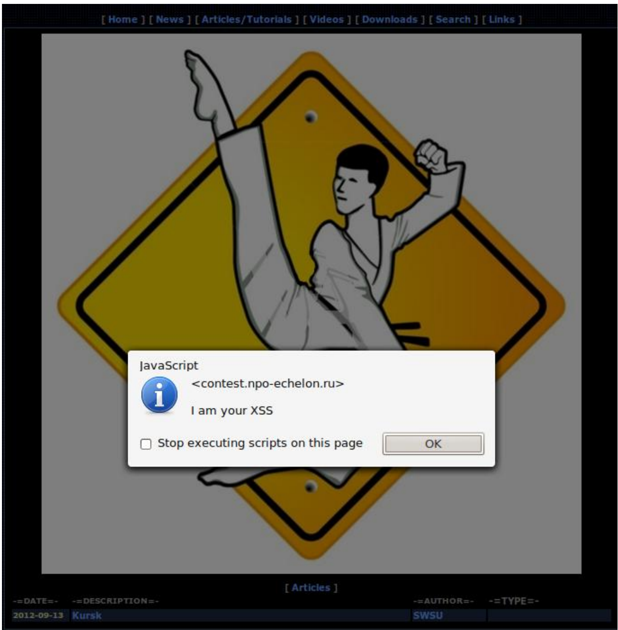
Рис. 10. Проверка успешности XSS-атаки (результат поиска по фразе “SWSU” на страничке http://contest.npo-echelon.ru/admin/searche.php )
